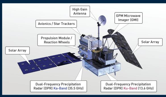
**GPM Core Observatory**
